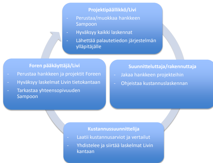
Kuva 2. Yksittäisen hankevaiheen kustannushallinnan yksinkertaistettu prosessi vastuun mukaisesti Liikenneviraston ja Elyjen hankkeissa.
